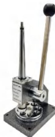
单头戒指扩缩器 Single head ring enlarger & reducer M.RS.00002-A 405×235×195mm 9.5kg
