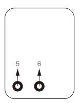
1、排水口: 机面漏斗出水口, 用1.5寸胶管接入, 并用1.5寸管箍锁紧。
